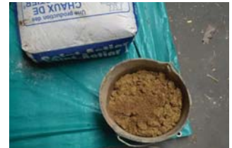
Enduit à la chaux
